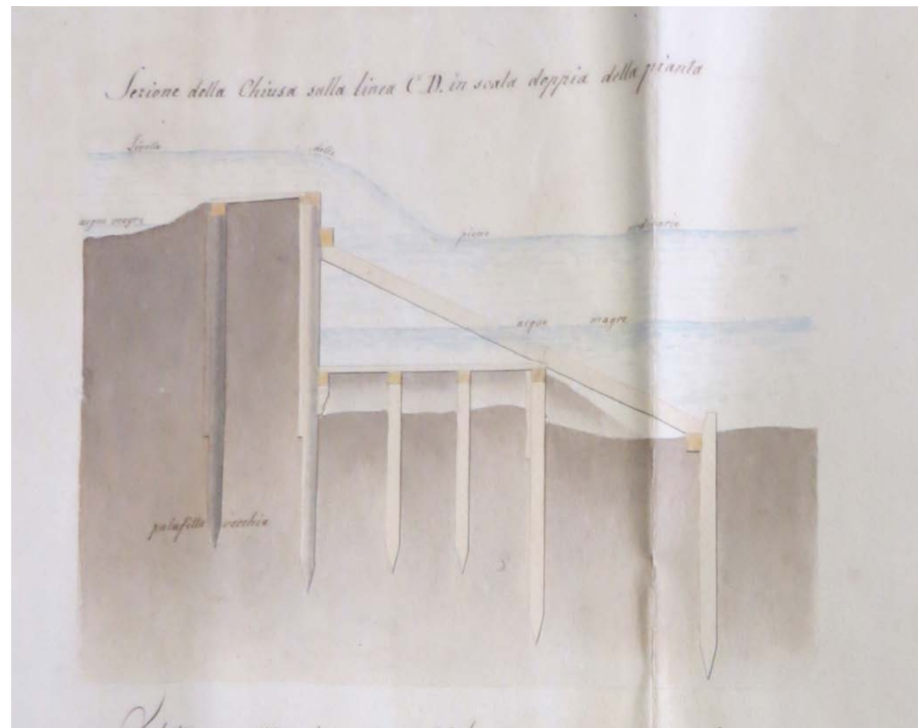
Fig. 2 – Sezione della chiusa
